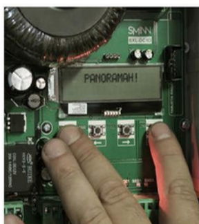
[2.1] Naciśnij jednocześnie przyciski BACK i ENTER aż zaświeci się wyświetlacz i pojawi się menu programowania.
